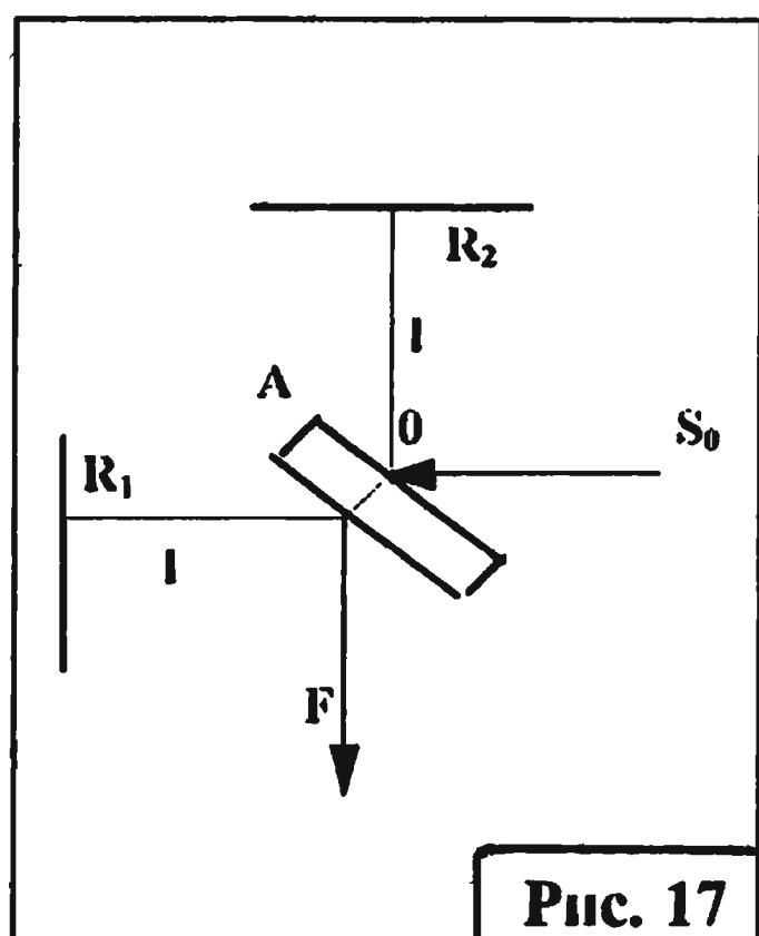
Главную роль в опыте играет интерферометр Майкельсона. Его схема показана на рис. 17 в упрощенном виде. Луч, идущий от источника  $S_0$ , отчасти отражается в точке 0 от стеклянной, слегка посеребрённой пластиинки A; он отражается от зеркала  $R_2$ , и часть его, пройдя через A, попадает в зрительную трубу, находящуюся в F. Другая часть луча  $S_0$  проходит через A, отражается от зеркала  $R_1$ , вновь отчасти отражается в 0 и также попадает в трубу F.
