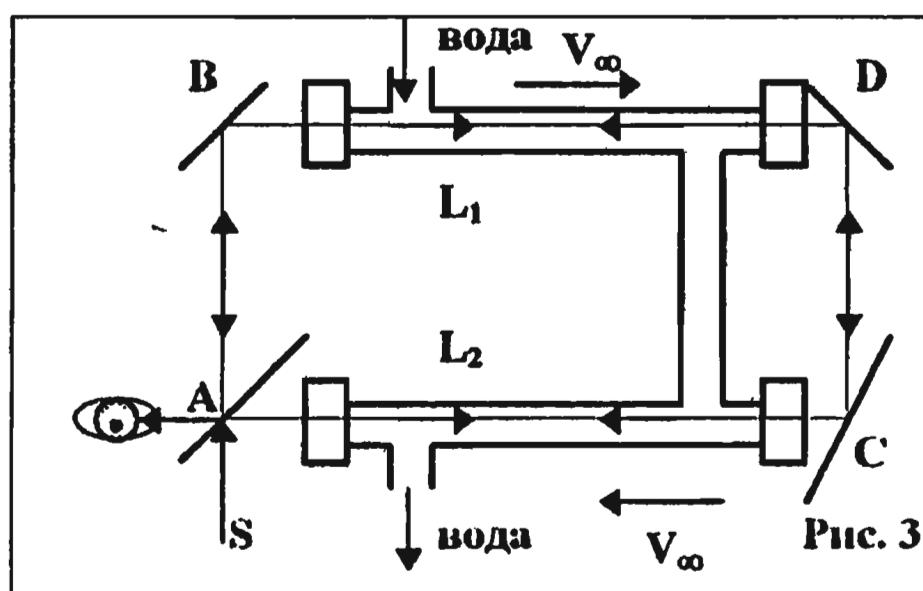
Опыт Физо проводился по следующей схеме. Световой луч S падал на полупрозрачную пластинку A, разделяющую его на два луча: AB и AC. Зеркала B, C и D, поставленные под углом 45° к падающим на них лучам, поворачивали их на углы 90°. Вследствие этого
