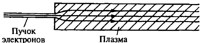
Рис. 4.16. Схема генерации плазменных волн в электронном пучке, проникающем в плазму
