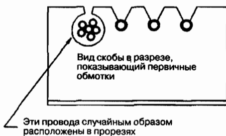
Рис. 14.17. Размещение первичной катушки на верхнем основании
