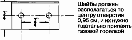
Рис. 18.7. Изготовление искрового разрядника
