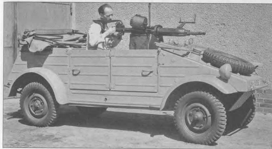
20-мм авиационная установка фирмы «Икаррия» на автомобиле. 1946 г.
