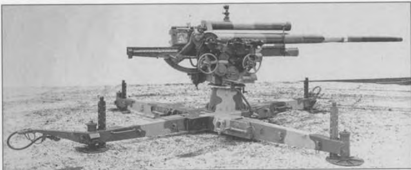
7,5-см зенитное орудие фирмы «Рейнметалл», поставленное в СССР в 1930 г (без колесного хода)
