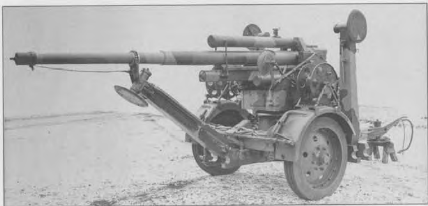
7,5-см зенитное орудие фирмы «Рейнметалл», поставленное в СССР в 1930 г в походном положении
