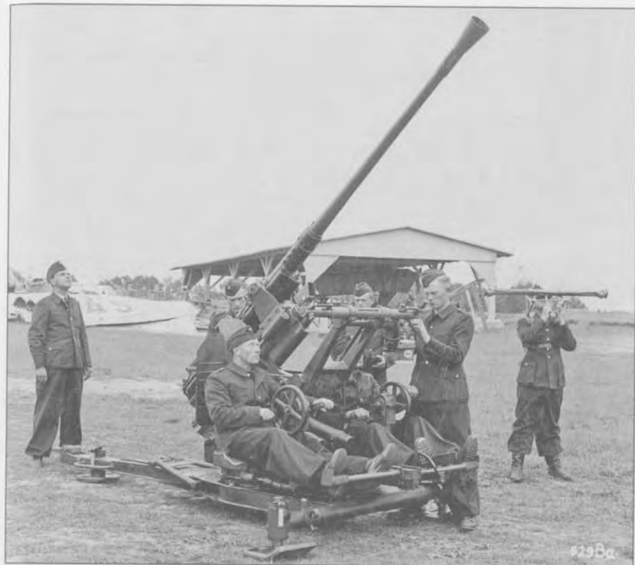
3,7-см автомат фирмы «Рейнметалл», поставленный в СССР в 1930 г.
