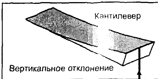
Рис. 7.7. Схема деформации кантилевера в процессе сканирования
