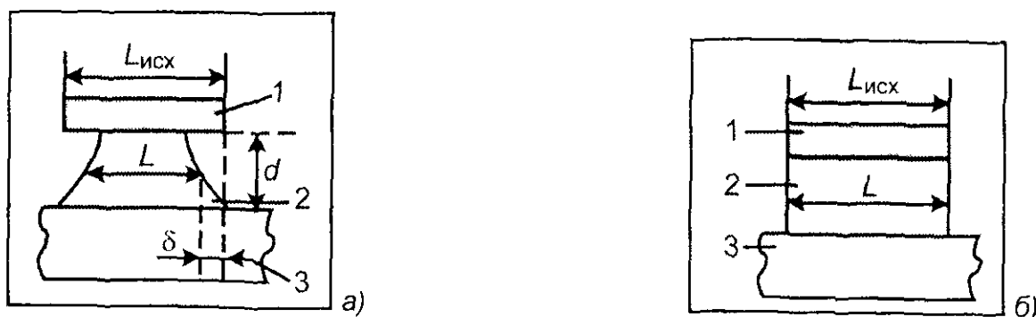
Рис. 5.21. Изотропный с боковым подтравом ( L_{исх} \neq L ) (а) и анизотропный ( L_{исх} = L ) характер травления (б)
