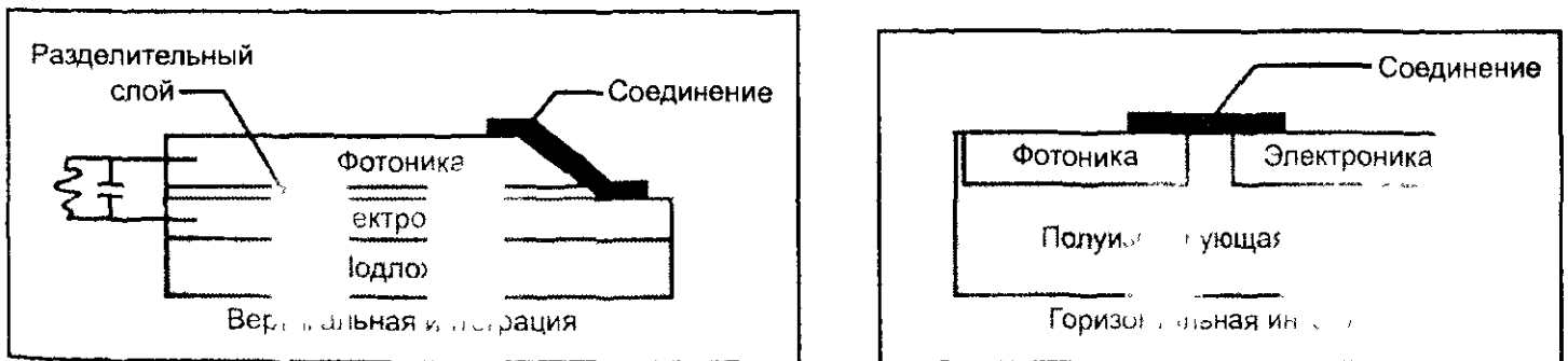
Рис. 7.6. Схема вертикальной и горизонтальной интеграции электроники и фотоники
